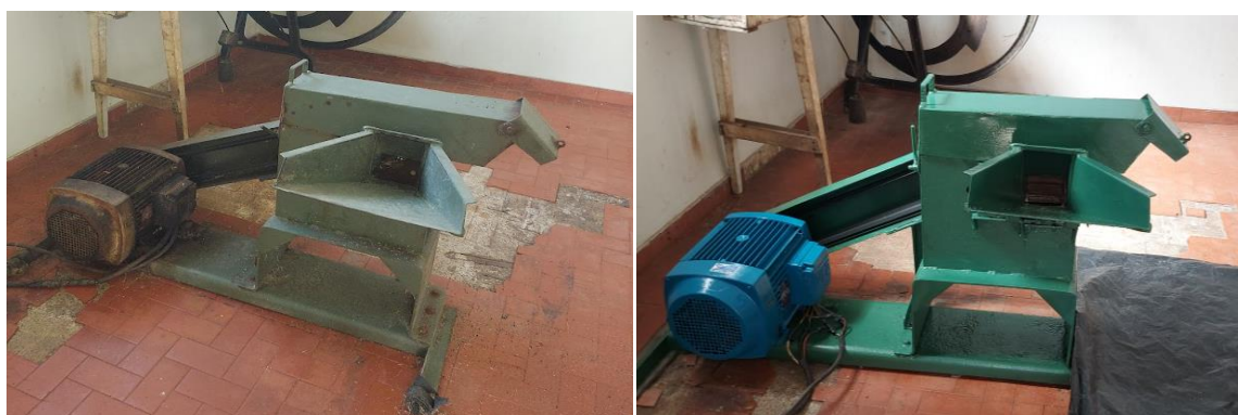
Reformas da máquina desfibradora de cana-de-açúcar do Centro de Análises. Antes (esquerda), Depois (direita).
